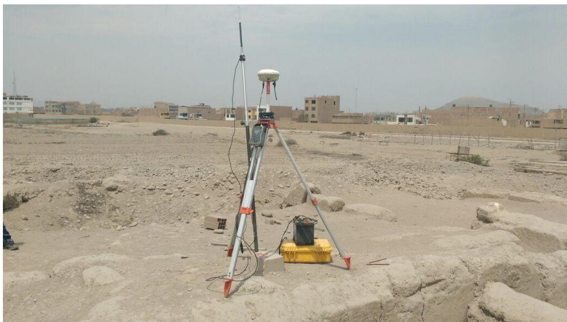
FOTOGRAFIA 01: VISTA DEL EQUIPO RTK, POSICIONADO.
