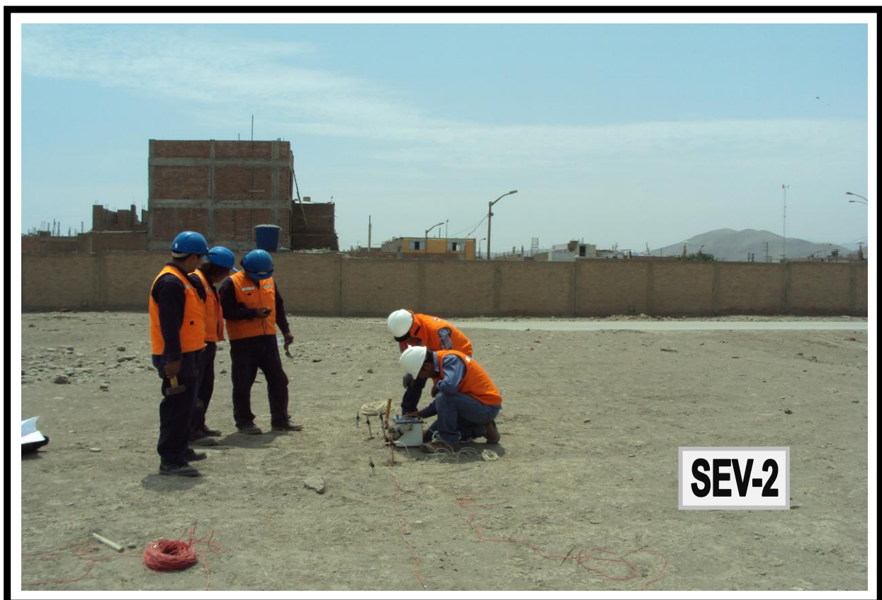
Fotografía 14 : Vista Mostrando el Sondaje Eléctrico Vertical (SEV-2), Realizado con Equipo de Resistividad Eléctrica.
