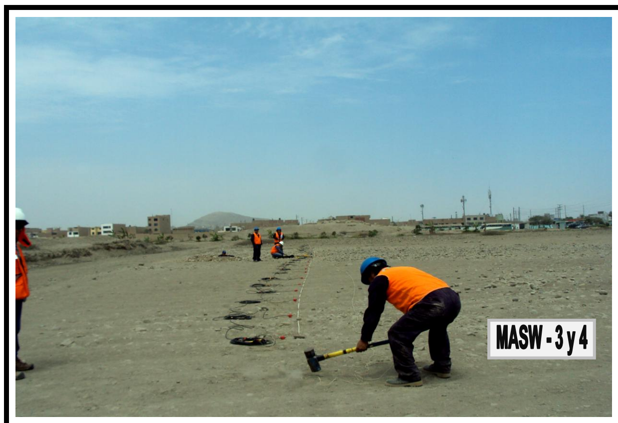
Fotografía 12 : Vista Mostrando los Sondajes MASW-3 y MASW-4 (Multichannel Analysis of Surface Waves) 1-D, Realizado con Equipo de Refracción Sísmica.
