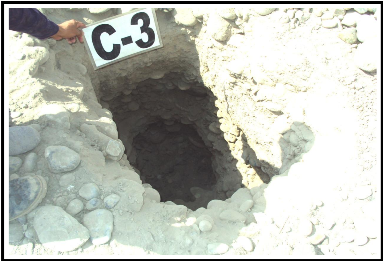
Fotografía 07 : Vista Interior de la Calicata (C-3). Se Puede Apreciar en el Fondo de la Excavación el Subsuelo Constituido por Grava Pobremente Graduada con Arena y Cantos (GP).
