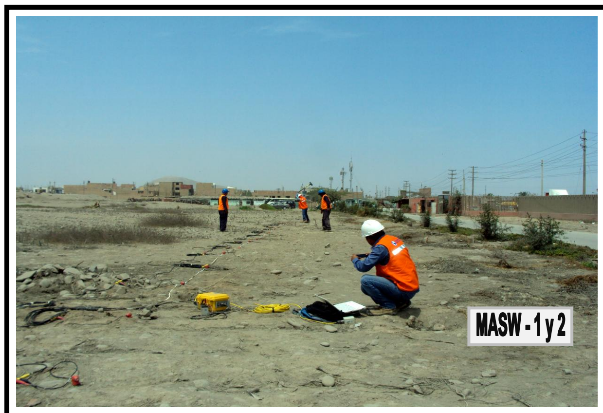
Fotografía 11 : Vista Mostrando los Sondajes MASW-1 y MASW-2 (Multichannel Analysis of Surface Waves) 1-D, Realizado con Equipo de Refracción Sísmica.
