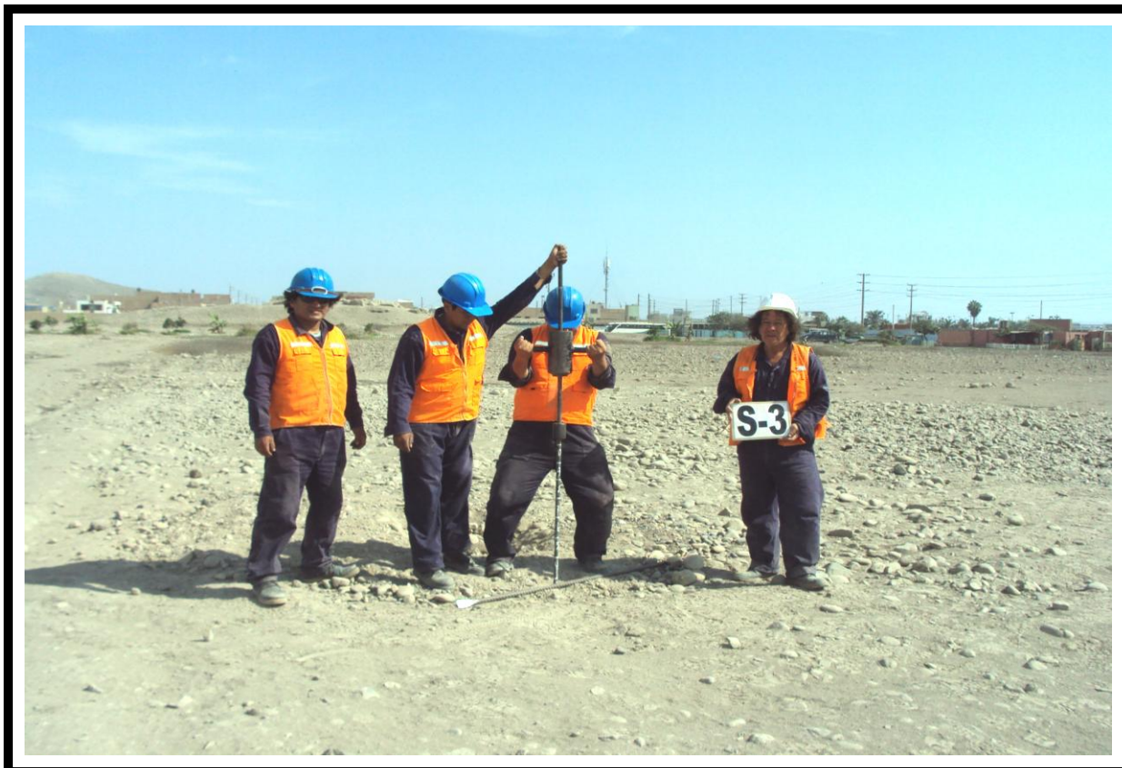
Fotografía 05 : Vista Mostrando el Sondaje (S-3), Realizado con Equipo de Penetración Dinámico (Cono de Peck).
